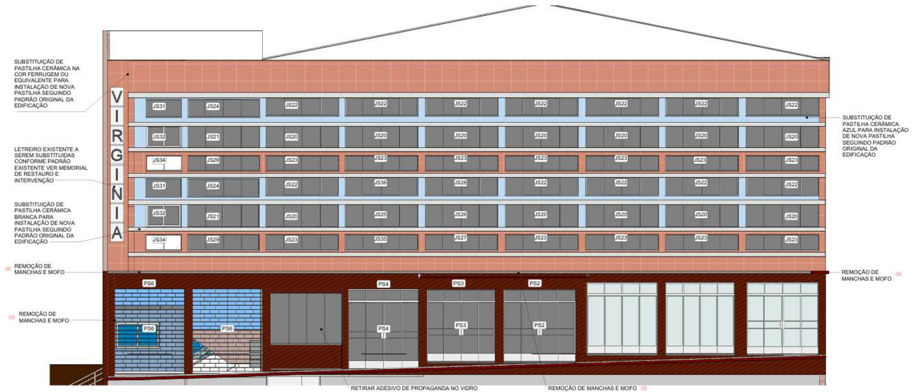
1 ELEVACÃO FRONTAL - DIRETRIZES DE RESTAURO ESCALA 1 : 75
